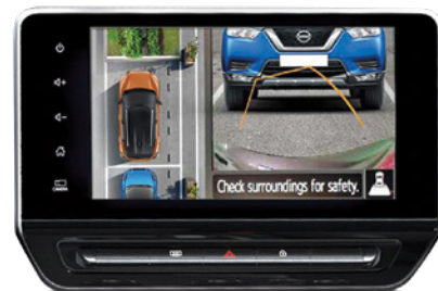
Vue arrière avec lignes de guidage pour le stationnement
